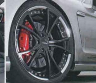
Dreiteilige 22-Zoll-Räder LSC-Forged, Stahlbremse
