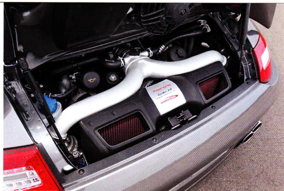
スピードアートが用意する複数のメニューの中から、試乗車は「パワーキットIV」と呼ばれる650hp/860Nmを発揮する仕様。ビッグタービンとその容量アップに伴うインタークーラーの換装、ECUの書き換えを施している。
