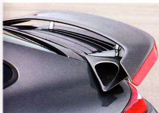
大型サイドインテークの内部にはデイタイムランニングライトとドライビングライトが収まる。エンジンカバー上のリヤウイングにはラムエアインテークが設けられ、エアボックスに冷却風を送り込む。エンドパイプは90mm径の4本出し。スピードアードオリジナルのLSC鍛造アルミホイールのサイズはⒺ: 8.5J×20、Ⓕ: 12.0J×20。
