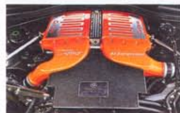
Im BMW-Maschinenraum bringt G-Power tatsächlich zwei Kompressoren und deren Peripherie unter
