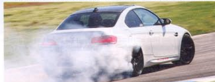
Dank Sperrdifferenzial verwandeln die Hecktriebler ihre Kraft je nach Gas-einsatz entweder in ausgezeichnete Traktion oder herben Gummiqualm
