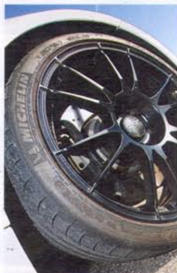
OZ-Räder zur Reduktion der ungefederten Massen gegenüber der Serie
