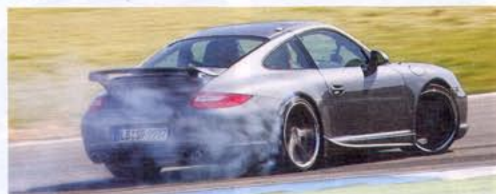
Dank Sperrdifferenzial verwandeln die Hecktriebler ihre Kraft je nach Gas-einsatz entweder in ausgezeichnete Traktion oder herben Gummiqualm
