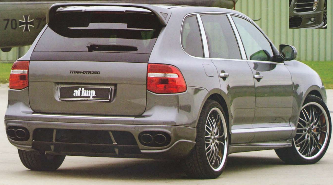
↑中央で折り返されたサイドスカート。大柄なカインのサイドビームを引き締めるポイントとなる ↑リアスポイラーはハーフタイプ。中央をディフューザー状に造形しつつ、マフラーの排熱も考慮されている ↑開口部から覗く左右出しのエキゾースト。テールエンドはマットブラック。裏みの効いたディテールだ ↑ホイールはクロスレーシングSUV。サイズは9.5×22インチ。ブレーキはツーリスモキットとして368φのローターとキャリパーをビルトイン ↑タテに仕込まれたディタイムライトとヘッドライトカバーもスピードアートのアイテム ↑BTRとは異なる形状のルーフスポイラー。大振りなマウンドとシンプルでウイングがカインを引き立てる
