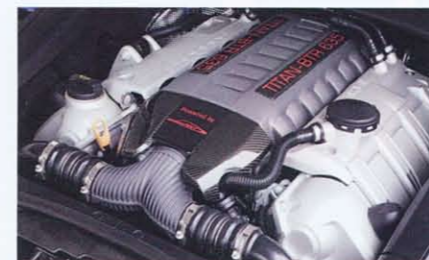
↑ エアフィルター、タービン、スポーツキャタライザー、エキゾースト、コンピュータを変更して635hpを発揮するエンジン。2.5トンの巨体を素早くドライブする
