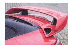
↑ スポイラーにはフレッシュエアを導入する巨大なインテークが備わっている。機能を引き上げるためのエアロデザインだ
