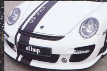
↑開口部が広げられたBTR-XLのフロント。カーボンエアダクトとリップスポイラーが追加され、より攻撃的なルックスを見せる
